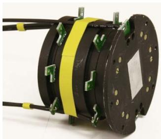
Prototype detector module (PSI)
