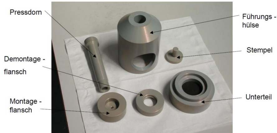
Die zerlegte Hochdruckzelle
